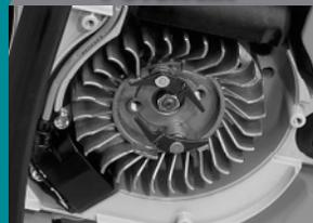
La función de apoyo de ignición almacena energía eléctrica en cada movimiento para facilitar el arranque
